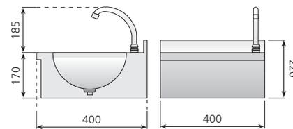
**Sistema PUSH:** pulsador temporizado oculto. Sistema de accionamiento que aporta seguridad y comodidad al ser utilizado, ya que no sobresale del lavamanos ningún elemento. Fácil de limpiar y con cómodo acceso a las piezas en caso de mantenimiento. Estética muy agradable y moderna.
